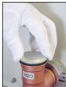
3. Insert dummy plug.
